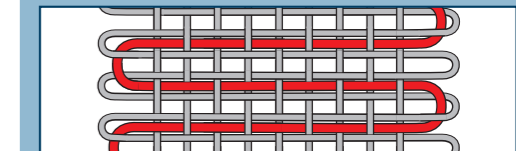
Abb.: Eingewebter Textildraht
